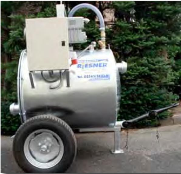
Diese Pumpaggregate eignen sich für die unterschiedlichsten Wasserhaltungsaufgaben im Vakuum- oder Schwerkraftverfahren, u.a. für die geschlossene Wasserhaltung mit Vakuumfiltern oder Vakuumtiefbrunnen, für offene Wasserhaltungen oder bei Drainagen- und Flachbrunnen.
