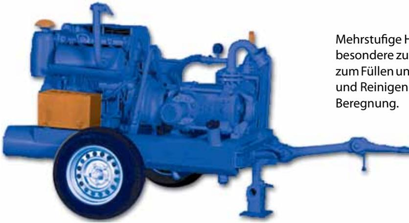
Mehrstufige Hochdruckpumpen dieser Bauart eignen sich insbesondere zum Einspülen von Filterbrunnen oder Pfählen und zum Füllen und Abdrücken von Rohrleitungen, zum Abspritzen und Reinigen von Baufahrzeugen, zur Brandbekämpfung und Beregnung.
